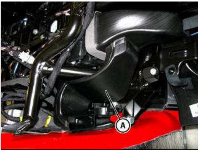
● 安装并紧固导管 (A)。
