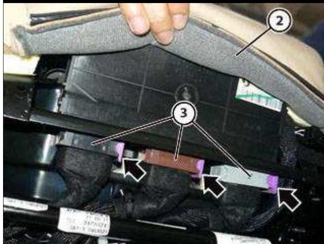
使盖 (2) 保持提起, 拧紧指示的螺母以紧固 ECU (A)。
