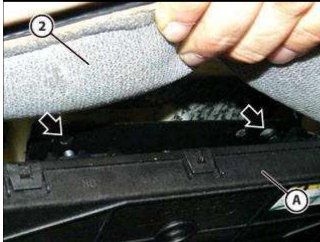
使盖 (2) 保持提起, 将 ECU (A) 的定位销安装到指示的孔中。
