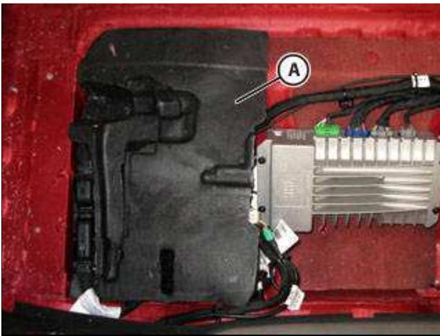
● 安装并紧固隔音层 (A)。
