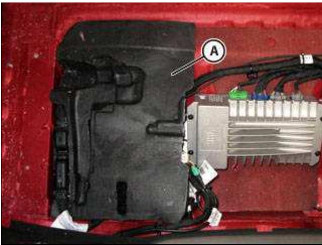
● 安装并紧固隔音层 (A)。
